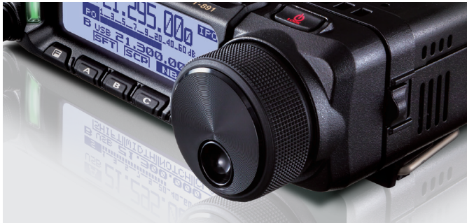
トルクコントロール付大型チューニングダイヤル
