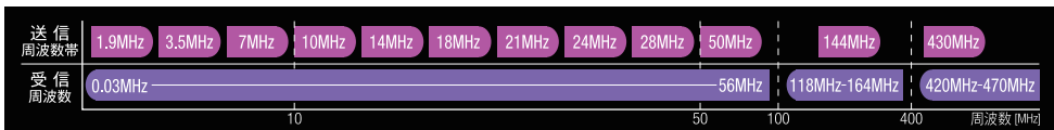
《HFからUHF帯までのワイドカバーレンジ対応》 ※保証範囲：アマチュアバンド周波数
